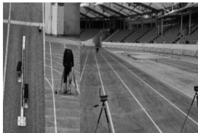
그림 2. Brower timing Smart start를 사용하여 스타트 출발 선에 손이 지면을 떨어지는 동시에 측정이 시작되며 30m 지점 센서를 통과 시 기록이 측정되도록 하였으며, 센서의 높이는 1m로 설정하였다. 100m도 동일하게 설정하였으며 2회 중 좋은 기록을 측정하였다.
